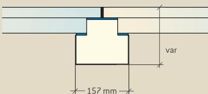
Der Skyfloor BS stellt in seinen Standardgrößen ein verbau- fertiges Komplettsystem dar, welches einen Rahmen mit integrierter Verglasung umfasst.
